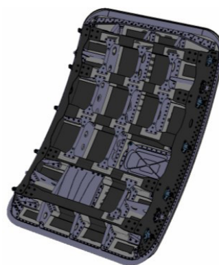
Figure 2 – Modèle 3D de la porte en composites et aperçu du moule réalisé par ATD/Avior (Lot 1)
