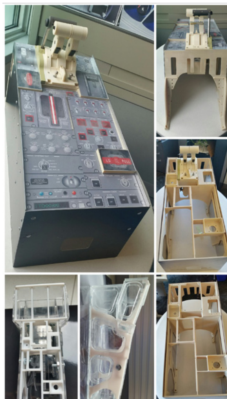
Figure 9 – Console centrale de poste de pilotage réalisée en fabrication additive
