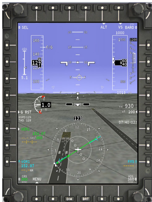
Figure 2 - Fonction de vision synthétique SureSight SVS
