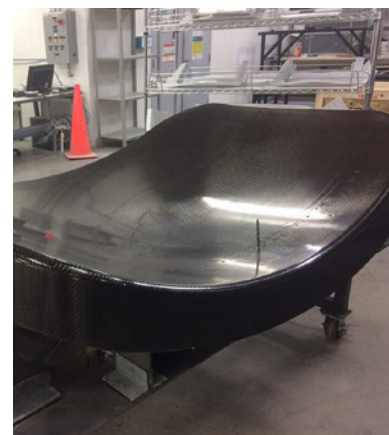
Figure 2 – Modèle 3D de la porte en composites et aperçu du moule réalisé par ATD/Avior (Lot 1)
