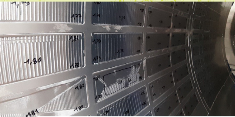
Figure 4 – Panneau de fuselage réalisé par usinage mécanique (Lot 3)
