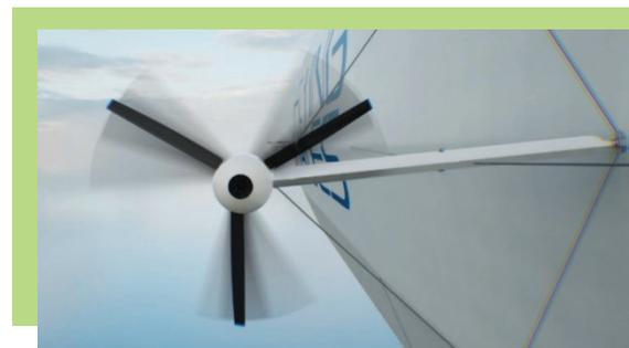
Un des 32 propulseurs électriques à hélice (concept 3D)
