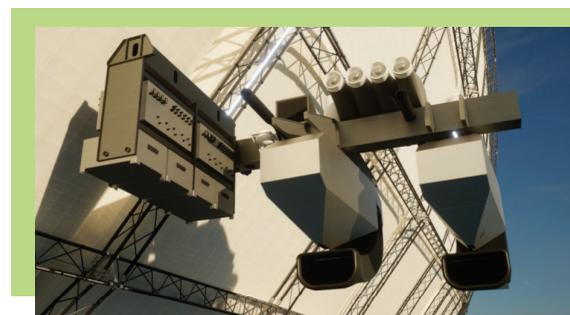
Vue - issue d'une vidéo de synthèse diffusée par Flying Whales - des turbogénérateurs à l'intérieur de la nacelle, fixés sur le dirigeable
