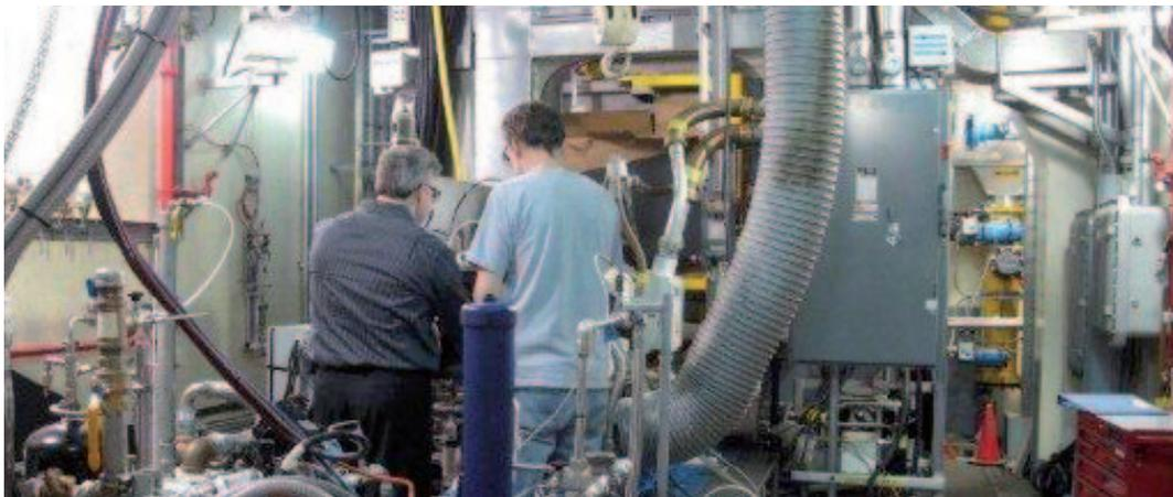
Banc d'essai de prochaine génération de moteur pour l'aviation générale (NEXT GEN GA)
