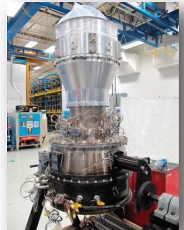
Banc d'essai du compresseur écologique de prochaine génération (NGRT)
