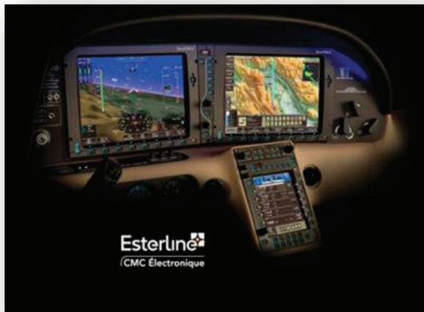
Esterline CMC Électronique (CMC) travaille à la conception d'un démonstrateur technologique de poste de pilotage incorporant de l'avionique modulaire intégrée.
