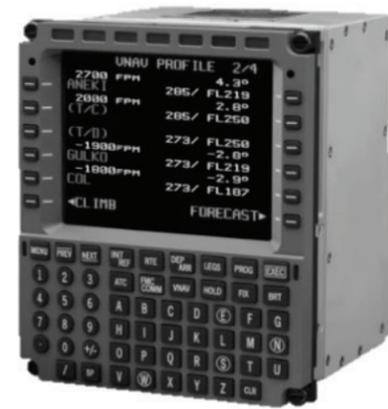
Photo 1. Interface usager classique (écran non tactile) de type MCDU (14 lignes de 24 caractères). L'unité est située dans une console entre les deux pilotes.
