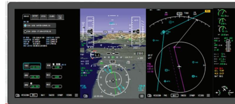
Photo 2. Interface usager avec écran tactile de grandes dimensions, ne nécessitant pas d'unité physique dédiée, mais étant plutôt hébergée dans une plateforme avionique modulaire intégrée (AMI), et occupant une portion de l'affichage principal de chaque pilote.
