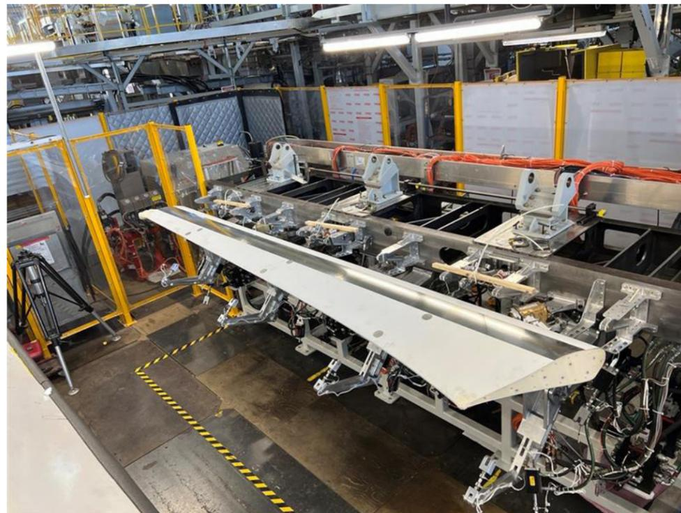
Photo 1. Partie électromécanique du banc d'essai dans les ateliers de Bombardier à Saint-Laurent. Visible en avant-plan est un des volets de la nouvelle aile. Le volet est fabriqué par PCM Innovation de Montréal. En dessous du volet se trouvent les actionneurs hydrauliques du système de simulation des charges aérodynamiques (pas encore attaché au volet). En avant du volet se trouvent les actionneurs électromécaniques du nouveau système d'actionnement de volets de Eaton Aerospace.
