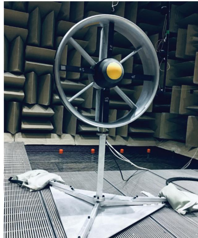
Mesures acoustiques d'un rotor caréné à propulsion électrique
