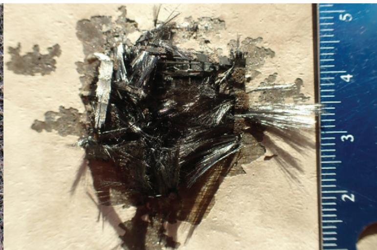
Photo 4. Échantillon endommagé par l'impact de foudre
