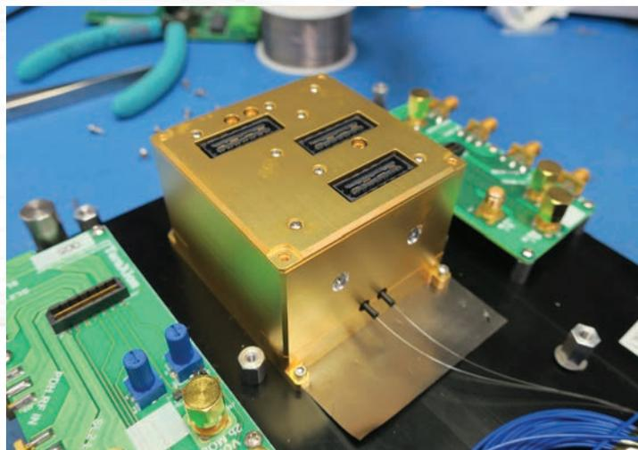
Figure 2 : En haut : Circuit électronique du prototype bêta de la source laser multifréquence conçu par Brioconcept, déplié et replié en module. En bas : Prototype bêta de la source laser multifréquence, dimensions  $60\text{mm} \times 60\text{mm} \times 45\text{mm}$ , volume  $162\text{cm}^3$ .
